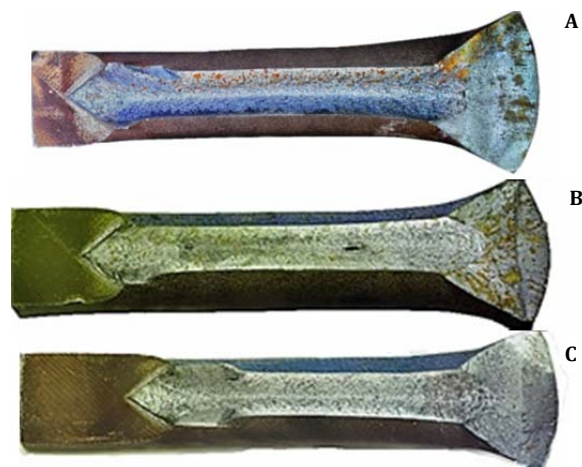
شکل ۱۷) نمای کلی سطح شکست نمونه آزمایش خمش سه نقطه‌ای با شیار شورون (A) ۵/۱، (B) ۱۰، (C) ۱۵ میلی‌متر
