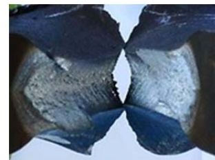
شکل ۱۵) رشد ترک به صورت فنجان- فنجان در نمونه آزمایش خمش سه نقطه‌ای
