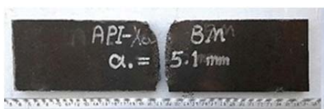
شکل ۱۱) نمونه آزمایشگاهی خمش سه‌نقطه‌ای با شیار اولیه ۵/۱ میلی‌متر پس از شکست لیگامنت در نیتروژن مایع
