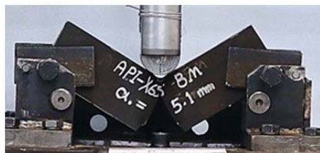
شکل ۱۰) رشد ترک و شکست در نمونه آزمایشگاهی خمش سه‌نقطه‌ای از جنس فلزپایه
