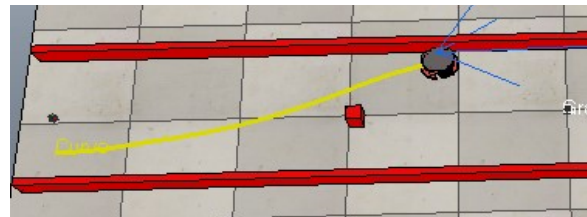
شکل ۱۰) مسیر حرکت ربات به روش بهینه‌سازی QUADPROG
