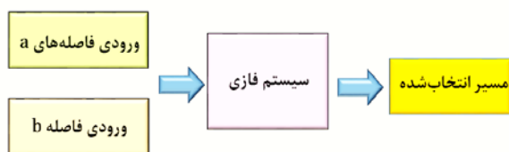
شکل ۳) بلوک دیاگرام ورودی-خروجی سیستم فازی
