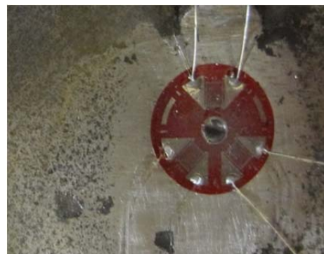
شکل ۲) آزمایش کرنش‌سنجی سوراخ
