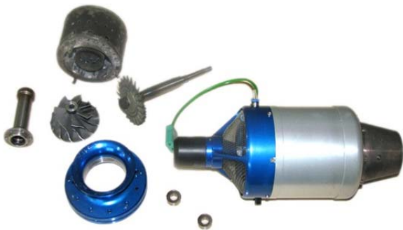
شکل ۲) موتور میکروتوربوجت رن ۱۰۰ و اجزای آن
