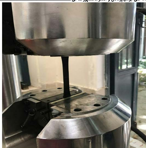
شکل ۹) نمونه نانوکامپوزیتی درون دستگاه تست خستگی
