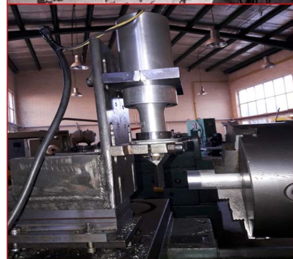
شکل ۲ ابزار UVT و تنظیمات اولیه آزمایش
