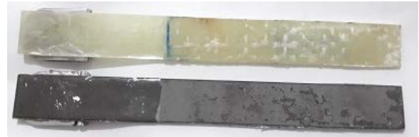
شکل ۱۱ سطوح شکست چندلایه کامپوزیتی و زیر لایه فولادی نمونه یک‌سرگردار دولبه نامتقارن
