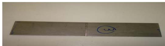
شکل ۳) نمونه جوشکاری شده به‌روش لیزر پالسی
