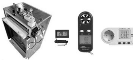
شکل ۱) ابزارهای سنجش کمی تحقیق؛ راست به چپ: انرژی‌متر، آنومتر، ترمومتر و مدولی از پوسته هموستاتیک
