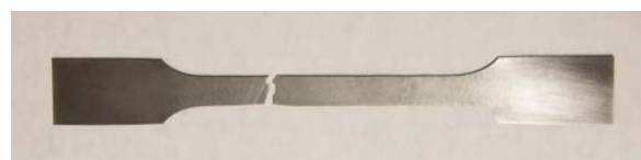
شکل ۹) نمونه آزمون کشش مفتول نورد شده پس از شکست
