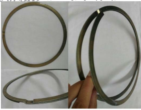
شکل ۱۰) نمونه آب‌بند مکانیکی لامینار ساخته شده
