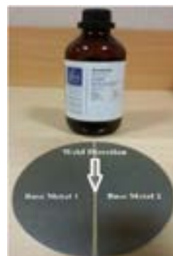
شکل ۱) آماده‌سازی سطح نمونه‌های بریده‌شده توسط استون
