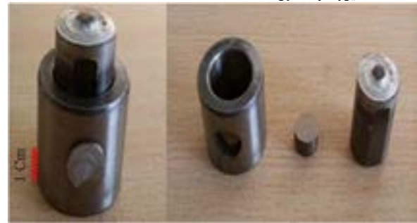
شکل ۳) مونتاژ و دمو نتاژ ابزار جوشکاری اصطکاکی اغتشاشی
