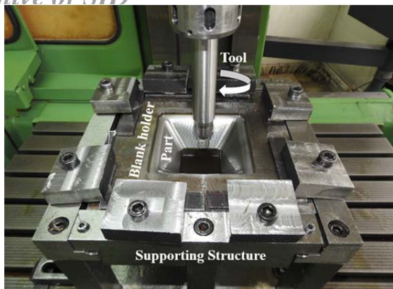
شکل ۴) تجهیزات به کاررفته برای فرآیند شکل‌دهی تدریجی تک‌نقطه‌ای هرم ناقص شامل مجموعه تکیه‌گاهی، صفحه پشتیبان و ماشین فرز سی‌ان‌سی
