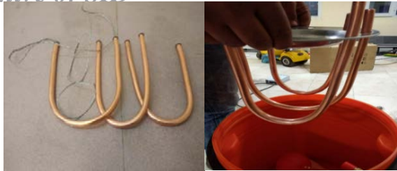
شکل ۵) ماده PMC پرشده در لوله‌های مسی U شکل
