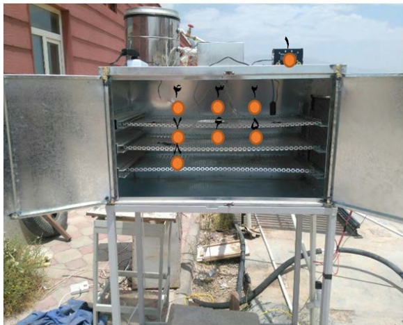
شکل ۱) محفظه خشک‌کن خورشیدی و نقاط مختلف اندازه‌گیری سرعت، دما و رطوبت
