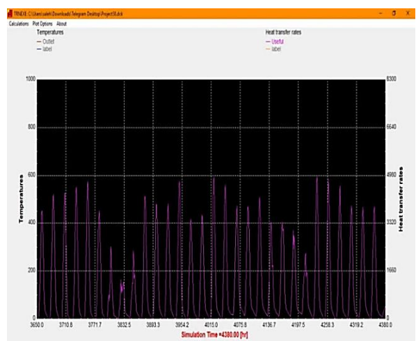
شکل ۴) گرمای مفید کلکتور مربوط به ماه ژوئن (مجموع گرمای مفید کلکتور در سال = 10.94kw و متوسط ماهانه گرمای مفید کلکتور = 0.9116Kw)
