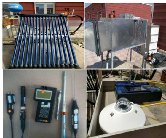
شکل ۳ (۱) سنسور AM۲۳۰۱، (۲) دیتالاگر، (۳) پیرانومتر، (۴) testo۴۵۴
