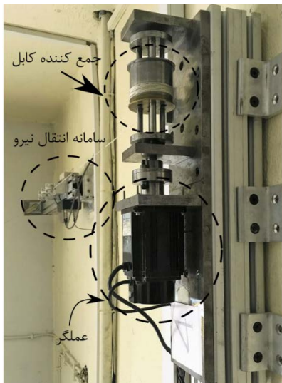
شکل ۳) سامانه کابل جمع‌کن و عملگر
