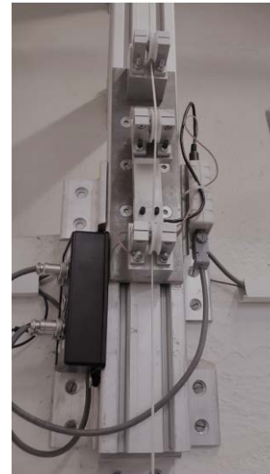
شکل ۴) سامانه طراحی شده به منظور اندازه‌گیری نیروی کابل در یک موقعیت ثابت
