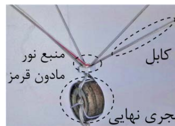
شکل ۴) سامانه طراحی شده به منظور اندازه‌گیری نیروی کابل در یک موقعیت ثابت
