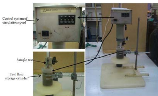
شکل ۱) تجهیزات آزمایش سایش با محفظه نگهدارنده سیال و نمونه با قابلیت اعمال دوره‌های متفاوت
