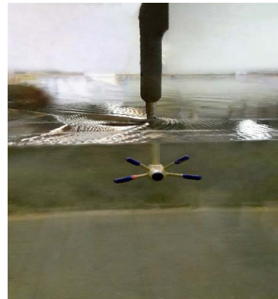
شکل ۱) نمایی از ایجاد تداخل دستگاه سرعت‌سنج صوتی دایر جانب‌نگر در جریان هنگام اندازه‌گیری سرعت (جهت جریان از راست به چپ می‌باشد).
