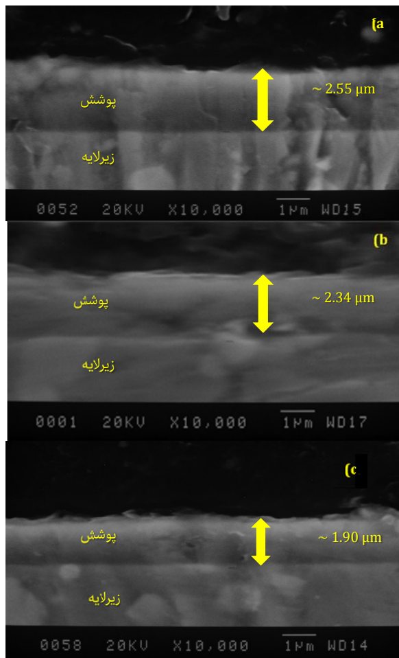
شکل ۳) تصاویر میکروسکوپی الکترونی روبشی از سطح مقطع نمونه‌ها به ترتیب در درصد چرخه‌کارهای: (a) ۲۵، (b) ۵۰ و (c) ۷۵
