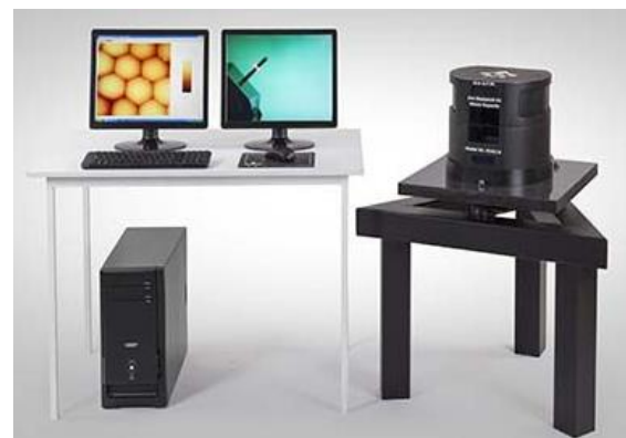
شکل ۶) میکروسکوپ نیروی اتمی Ara-Research Multi-Mode برای آزمودن تیرک در محیط هوا (برگرفته از سایت شرکت آرا پژوهش [23] )
