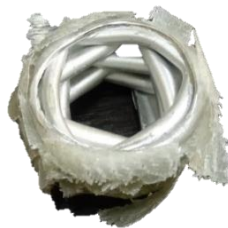
شکل ۱۵) نمونه ترکیبی آلومینیوم/کامپوزیت با درصد هم‌پوشانی ۵ درصد بعد از اعمال بارگذاری.
