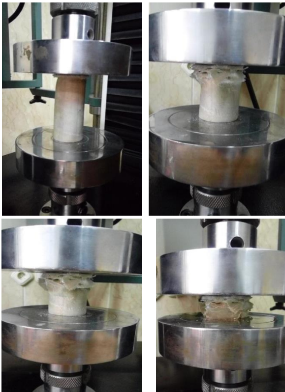
شکل ۱۱) نمونه ترکیبی آلومینیوم/کامپوزیت تحت بارگذاری فشاری شبه استاتیکی.
