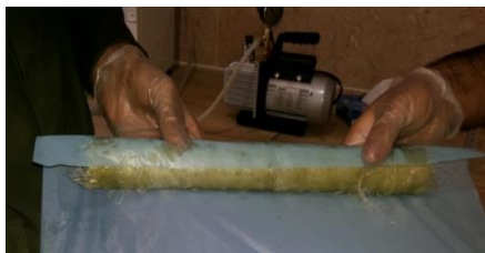
شکل 7 پیچش لایه نایلون متخلخل به دور نمونه.
