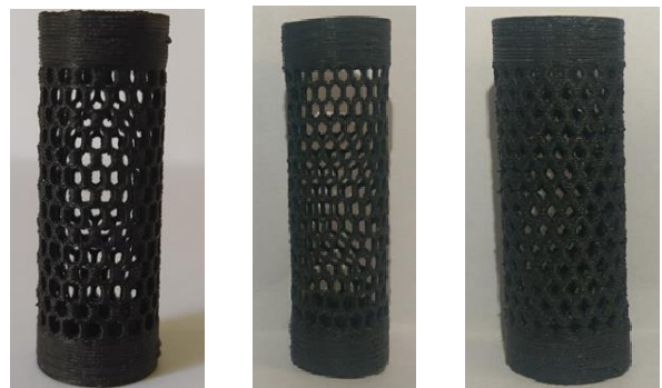
شکل ۷ استنت چاپ شده، (الف) مشبک لوزی شکل (ب) مشبک لانه‌زنبری (ج) مشبک بیضی شکل
