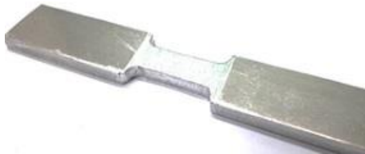
شکل ۵) نمایی از نمونه پس از عملیات سطحی کوبش فراصوتی
