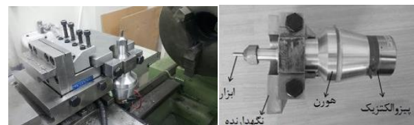
شکل ۳) ابزار کوبش فراصوتی و نگره‌دارنده (ب) نگره‌دارنده و اتصال ابزار کوبش فراصوتی روی دستگاه
