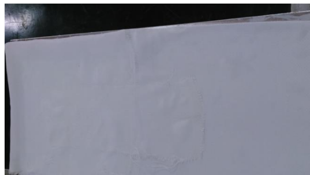
شکل ۵) پارچه الیاف E-glass آغشته به محلول تفلون پس از یک ساعت حرارت دادن در کوره.
