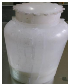
شکل ۱) پارچه از جنس شیشه E-Glass و محلول تفلون با درصد وزنی ۶۰ درصد.
