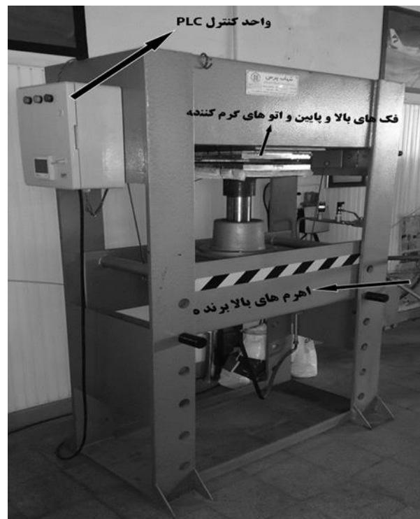
شکل ۳) دستگاه پرس گرم با واحد کنترل کنترل PLC و تشریح قسمت‌های آن.
