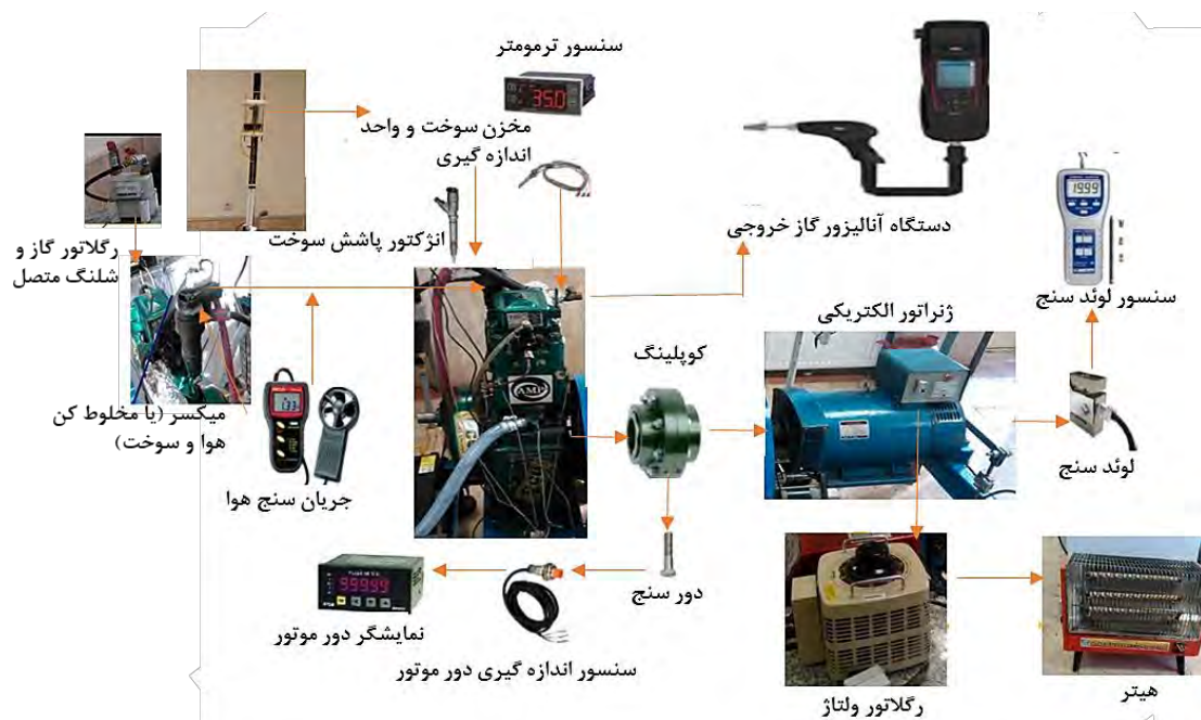
شکل ۵) تجهیزات آزمایش و موتور دیزلی
