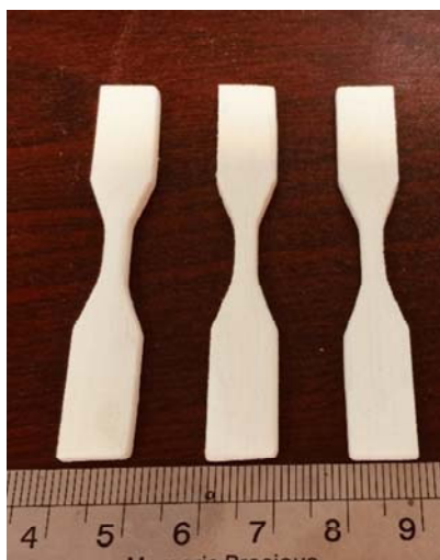
شکل ۳) نمونه‌های سرد شده به سه روش ساخته شده مختلف (برای هر حالت سه نوبت آزمون انجام شده است)
