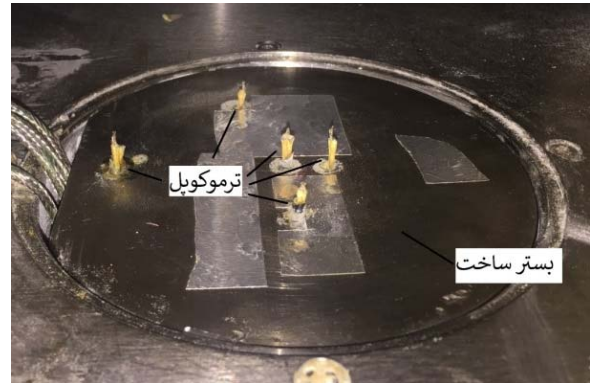
شکل ۱) جایگذاری ترموکوپل در بستر ساخت جهت ثبت تغییرات دمای داخل پودر، موقعیت ترموکوپل ها می تواند بسته به محل ساخت نمونه ها متفاوت باشد.
