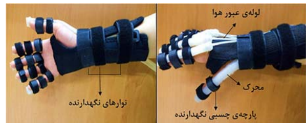
شکل ۶) دستکش نرم پس از مونتاژ و سوارشدن روی دست در حالت غیرفعال در دو نمای جداگانه
