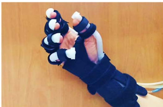
شکل ۹) مود تناسبی دستکش در فشار ۱۷/۰مگاپاسکال و مقادیر خمش متفاوت انگشتان نسبت به یکدیگر
