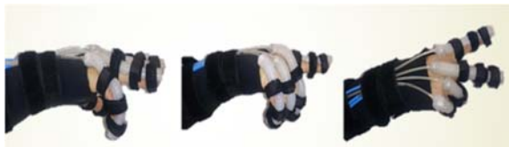
شکل ۷) مود روشن/خاموش دستکش در فشار ۱۷/۰مگاپاسکال و ایجاد وضعیت‌های متفاوت قرارگیری انگشتان
