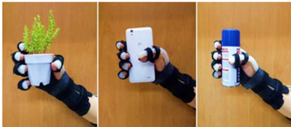
شکل ۸) بلندکردن اجسام مختلف با هندسه گوناگون به کمک دستکش در مود روشن/خاموش در فشار ۱۷/۰مگاپاسکال
