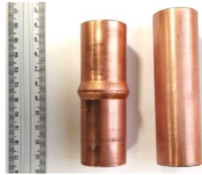
شکل ۲) تصویر لوله قبل از انجام فرآیند و نیز حین انجام فرآیند انبساط و روزن‌رانی تناوبی شکل‌دهی هیدرواستاتیک لوله
