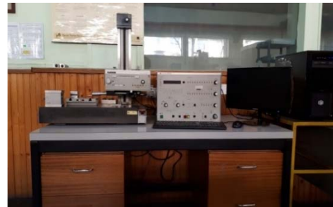
شکل ۴) دستگاه زبری‌سنج تیلور هابسون
