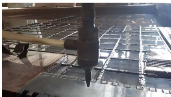
شکل ۲) نمونه‌ای از مراحل ماشینکاری با جت آب و ساینده روی فولاد هاردوکس
