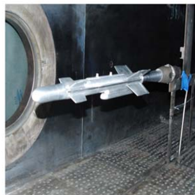
شکل ۴) نمایی از مدل موشک نصب شده در تونل باد دانشگاه جامع امام حسین ع
