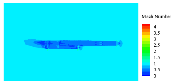
شکل ۹) کانتور ماخ حاصل از حل عددی در ماخ ۰/۸۵
