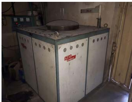
شکل ۳) تصویری از کوره عملیات حرارتی
