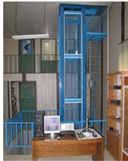
شکل ۲) دستگاه آزمایش ضربه سقوطی استفاده شده در این تحقیق
