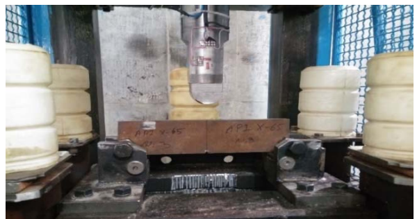
شکل ۳) نمونه فولاد قرار گرفته شده زیر چکش دستگاه ضربه سقوطی
