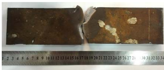
شکل ۸ تصویر نمونه شکسته شده پس از انجام آزمایش ضربه سقوطی
