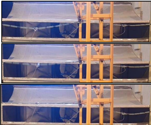
شکل ۶) شکل شماتیک و سه فریم تصویربرداری شده در آزمایشگاه تونل باد مربوط به سازوکار ایجاد نوسان تک‌حلقه تاخت‌باد در اثر اندرکنش دهنه‌های مجاور
