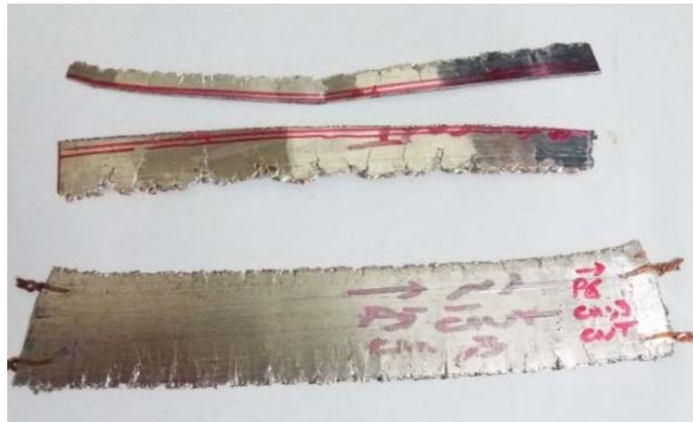
شکل ۹) تصویر نمونه‌های نانوکامپوزیتی آلومینیم- مس (با ضخامت ۳/۰ میلی‌متر)- نانولوله کربنی (۲/۰٪ وزنی) پس از اعمال شش سیکل نورد (پایین)، بخش‌هایی از نمونه تخریب‌شده به دلیل شکنندگی زیاد (بالا)
