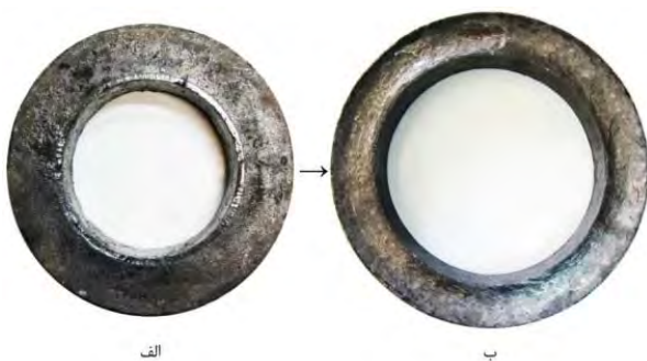
شکل ۱۱) الف) حلقه ریخته‌گری شده (حلقه شماره ۰۰، ب) حلقه نورد شده با سرعت دورانی غلتک اصلی ۲۰RPM و سرعت خطی مندرل ۰/۶mm/s (حلقه شماره ۴)
