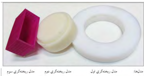
شکل ۶) مدل‌های مورد استفاده در ریخته‌گری حلقه‌های دولایه
