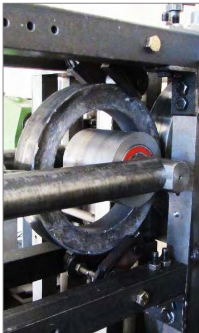
شکل ۱۰) دستگاه نورد حلقه مورد استفاده جهت انجام آزمون‌های تجربی
