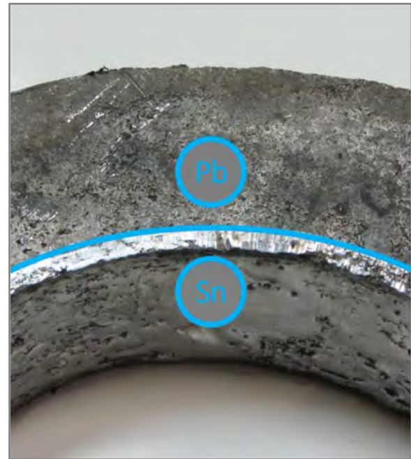
شکل ۸) نمایی نزدیک از حلقه دولایه و نمایش جنس لایه‌های آن
