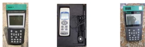
شکل ۳) دستگاه های اندازه گیری (a) داماسنج (b) شدت سنج (c) وات متر
