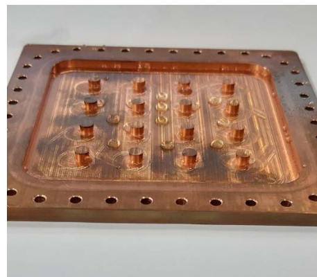
شکل ۴ سطح آبگریز شده بخش چگالش
