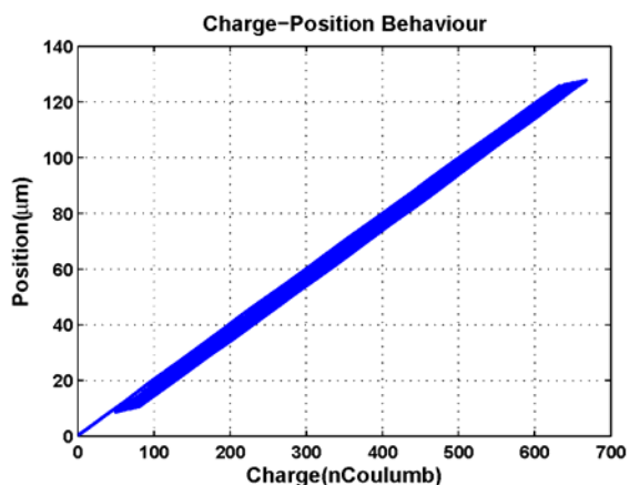
نمودار ۲) رابطه بار- جابجایی در عملگرهای پیزوالکتریک در حضور نشتی بار
