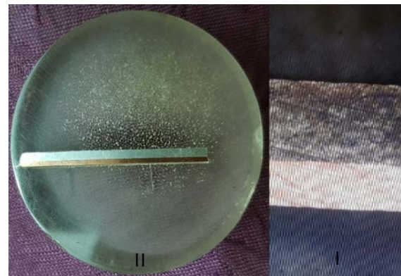
شکل ۱) قراردادن و پرداخت کاری مقطع ورق دوفلزی آلومینیوم- مس و تصویر VMM گرفته‌شده از نمونه
