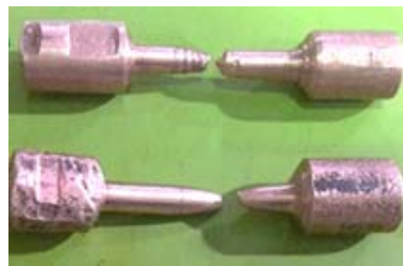
شکل (۱۳) نمونه کشش‌های گسیخته‌شده
