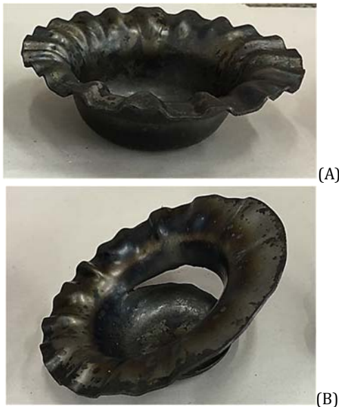
شکل ۱۰ نمونه های شکل‌دهی‌شده در دمای ۷۰۰ درجه سانتی‌گراد: (A) روان‌کاری توسط ترکیب گریس و گرافیت، (B) روان‌کاری توسط گرافیت
