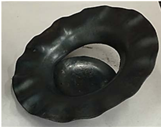
شکل ۷) نمونه شکل‌دهی شده در دمای ۷۵° درجه سانتی‌گراد
