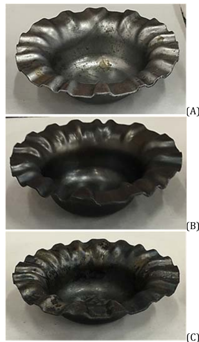
شکل ۲) نمونه‌های شکل گرفته از آزمایش در دماهای مختلف؛ الف) دمای ۷۰۰ درجه سانتی‌گراد، ب) دمای ۵۰۰ درجه سانتی‌گراد، ج) دمای ۷۰۰ درجه سانتی‌گراد
