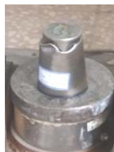
شکل ۵) الف) جاذب مخروطی ۱؛ قبل از آزمایش (شکل راست) و بعد از آزمایش (شکل چپ)، ب) جاذب مخروطی ۲؛ قبل از آزمایش (شکل راست) و بعد از آزمایش (شکل چپ)، ج) جاذب مخروطی ۳؛ قبل از آزمایش (شکل راست) و بعد از آزمایش (شکل چپ)
