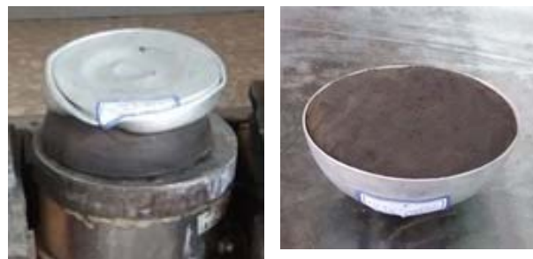
شکل ۷) جاذب نیم‌کروی پرشده با فوم؛ قبل از آزمایش (شکل راست) و بعد از آزمایش (شکل چپ)
