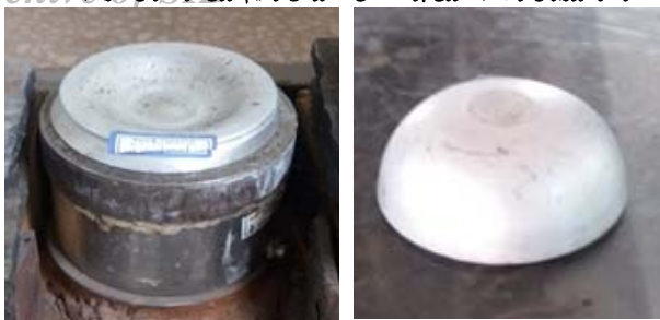
شکل ۶) جاذب نیم‌کروی توخالی؛ قبل از آزمایش (شکل راست) و بعد از آزمایش (شکل چپ)
