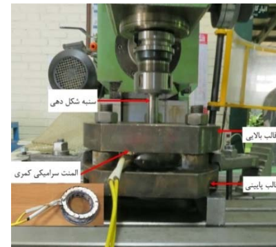
شکل ۱) (الف) ابعاد ابزار شکل‌دهی، (ب) مجموعه دستگاه شکل‌دهی بدون قالب لوله
