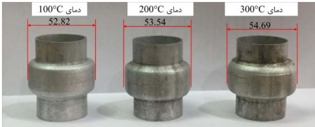
شکل ۳) نمونه‌های شکل‌داده‌شده در دماهای مختلف با گام و عمق شکل‌دهی ۵/۰ میلی‌متر
