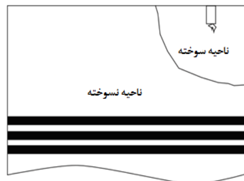
شکل ۱) ناحیه سوخته و نسوخته در داخل محفظه احتراق
