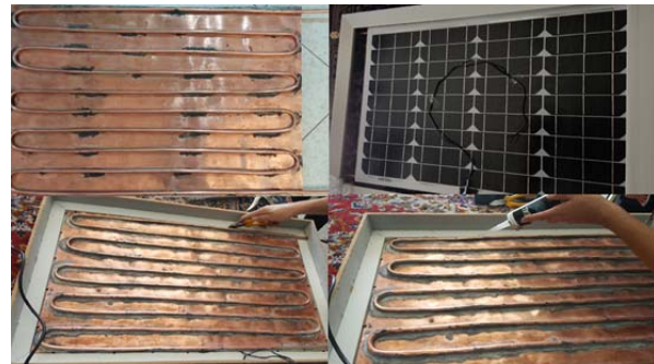
شکل ۸) جزئیات ساخت دستگاه کلکتور ترکیبی فتوولتائیک- حرارتی
