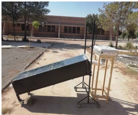
شکل ۱) تصویر خشک‌کن و صفحه فتوولتائیک استفاده‌شده در تحقیق حاضر
