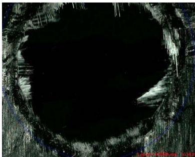
شکل ۷ مقایسه کیفیت سوراخ در سوراخ کاری اولتراسونیک و سرعت برشی ۳۵ متر بر دقیقه در حالت: (الف) بدون نانولوله چندجداره کربنی، (ب) ۵٪ نانولوله چندجداره کربنی
