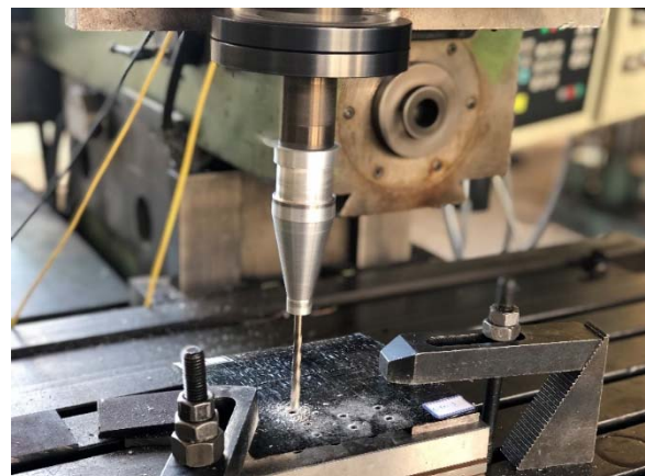
شکل ۴) آماده‌سازی فرآیند سوراخ کاری اولتراسونیک
