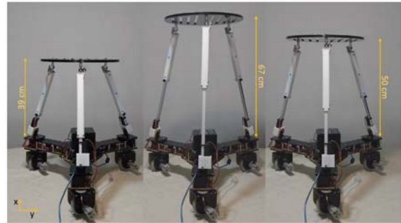
شکل ۹ آزمون پارامتر Altitude: الف) ارتفاع ۵۰ سانتی‌متر، ب) بیشترین ارتفاع استوارت پلتفرم، ج) کمترین ارتفاع استوارت پلتفرم
