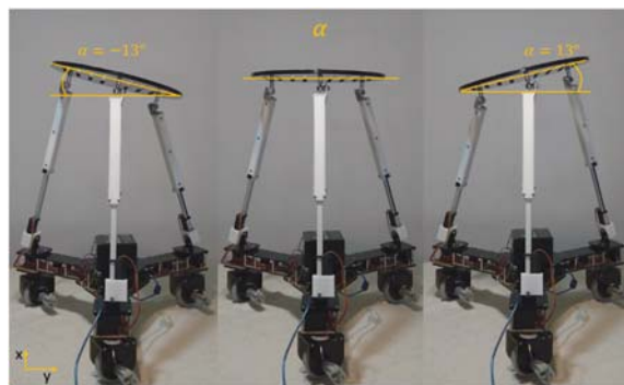
شکل ۱۰ آزمون پارامتر \alpha : الف) \alpha با زاویه ۱۳ درجه، ب) \alpha با زاویه صفر درجه، ج) \alpha با زاویه ۱۳- درجه
