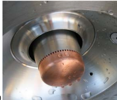
شکل ۳) تصویر انژکتور پینتل دارای تعدادی شکاف در تست سرد با آب؛ الف: نمونه تراست بالا، ب: نمونه تراست پایین
