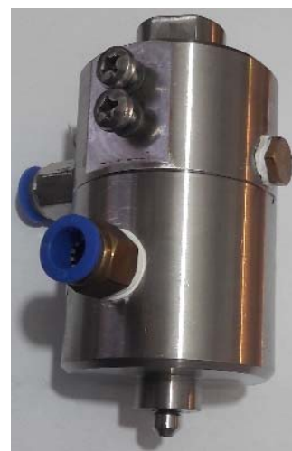
شکل ۷ تصویر نمونه اولیه ساخته‌شده انژکتور پینتل
