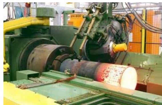
شکل ۱) ساخت مخزن از لوله بدون درز
