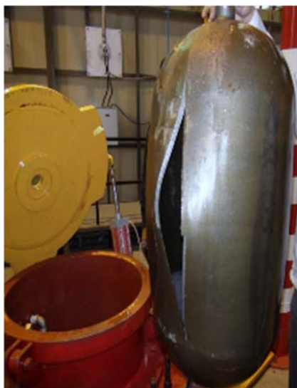
شکل ۳) مخزن مورد آزمون در فشار نهایی
