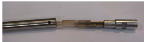
شکل ۵) نمایی از حسگر سه‌سوراخه مورد آزمایش
