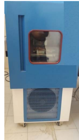
شکل (۱) الف) حس گر محصول شرکت Analog Device استفاده شده در آزمایش تجربی، ب) محفظه مورد استفاده جهت آنالیز دمایی
